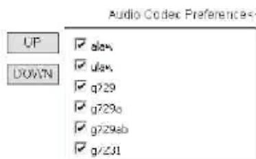
Если кодек сжатия отмечен, это значит, что он доступен и используется.
